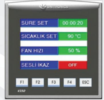
**Kumaş numunelerinin boyama ve yıkama işlemlerinden sonra kurutma ve fiksesi için kullanılır. Dahili buhar üretici ile kumaş üzerine doymuş buhar verilir (220 °C). İç kabin tamamen paslanmaz çeliktir. Kumaş numunelerini sabitlemek için iğneli ve ayarlanabilir çerçeveler mevcuttur. Kurutma işlemi istenilen zaman, sıcaklık ve hava hızı ile gerçekleştirilir. İşlem sonunda numune otomatik olarak dışarı çıkarılır. Maksimum sıcaklık 250 °C, maksimum numune ebatları 350 mm x 350 mm dir.**
